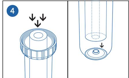
Buka kemasan kartrid baru dan masukkan kartrid ke dalam badan housing. Posisikan lubang kartrid pada pin di dasar badan housing.
