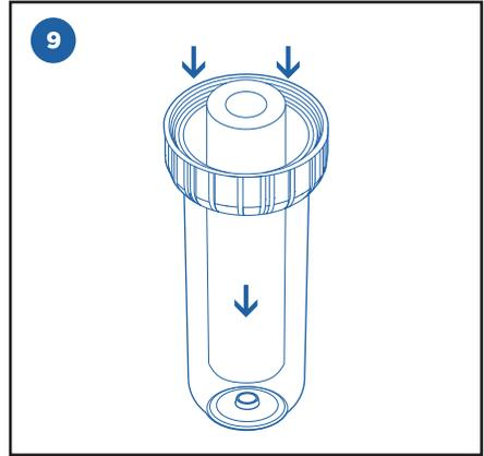
Lepas kemasan kartrid lalu masukkan ke dalam housing. Pastikan posisi kartrid terpasang pada pin di dasar housing.
